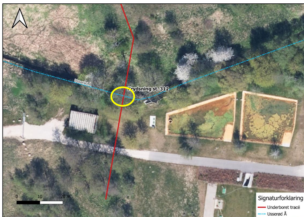
Figur 6-2 Krydsning af Usserød Å ved Sjælsø Vandværk i Hørsholm Kommune. På kortet er angivet vandløbs stationering, i henhold til regulativ. Vandløbskrydsningen er markeret med gul cirkel.
