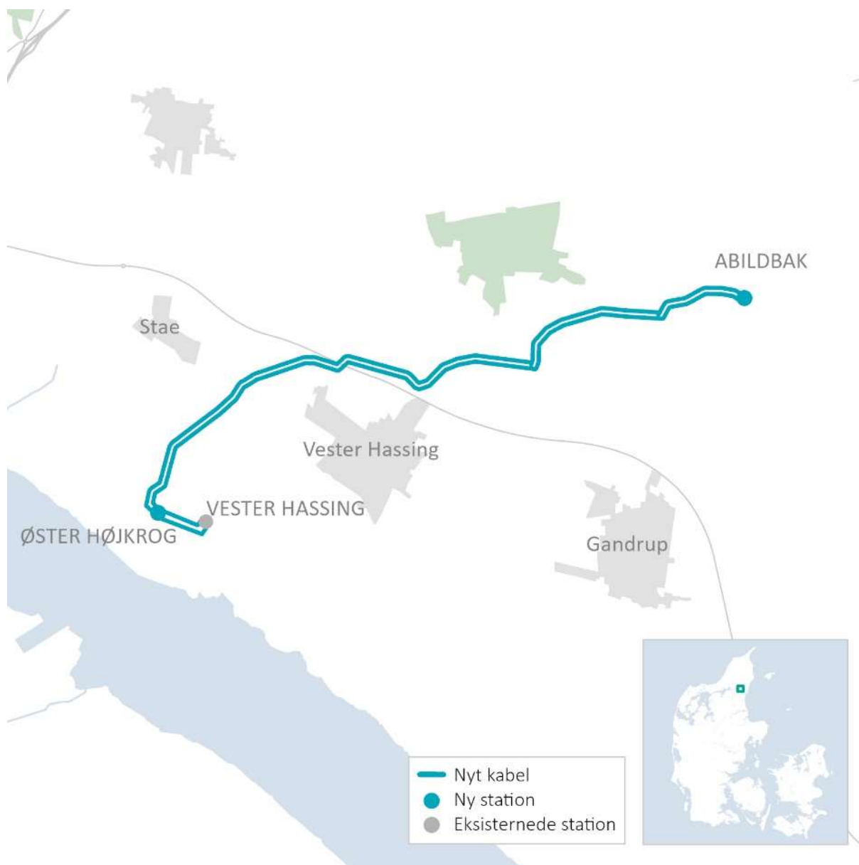
Figur 1.1 - Placering af projektet, med markering af de to nye 150 kV højspændingsstationer, Abildbak og Øster Højkrug, den eksisterende højspændingsstation, Vester Hassing, samt de jordkabler, der forbinder stationerne. Kilde: Indpasning af transmission af vedvarende energi i Nordjylland: Etablering af fire nye højspændingsstationer og to kabelstrækninger .
