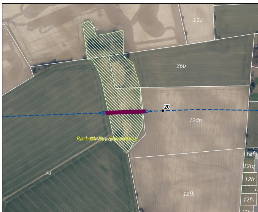
Figur 1-2. Et § 3 beskyttet engområde krydses ved en styret underboring over en længde på ca. 100 m.
