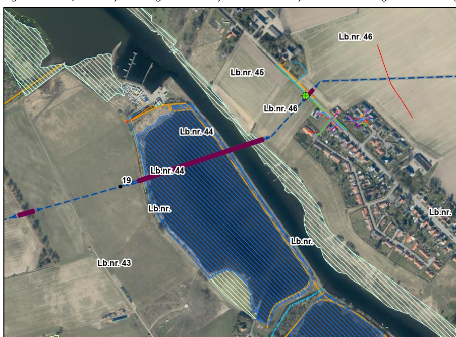
Figur 1-2. Et § 3 beskyttet engområde krydses ved en styret underboring over en længde på ca. 100 m.
