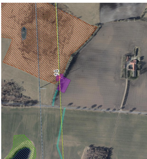
Figur 2-8. Placering af mast 14 i kanten af moseområde. På foto ses (meget tydeligt) mast fra nærliggende 400 kV linjeføring.
