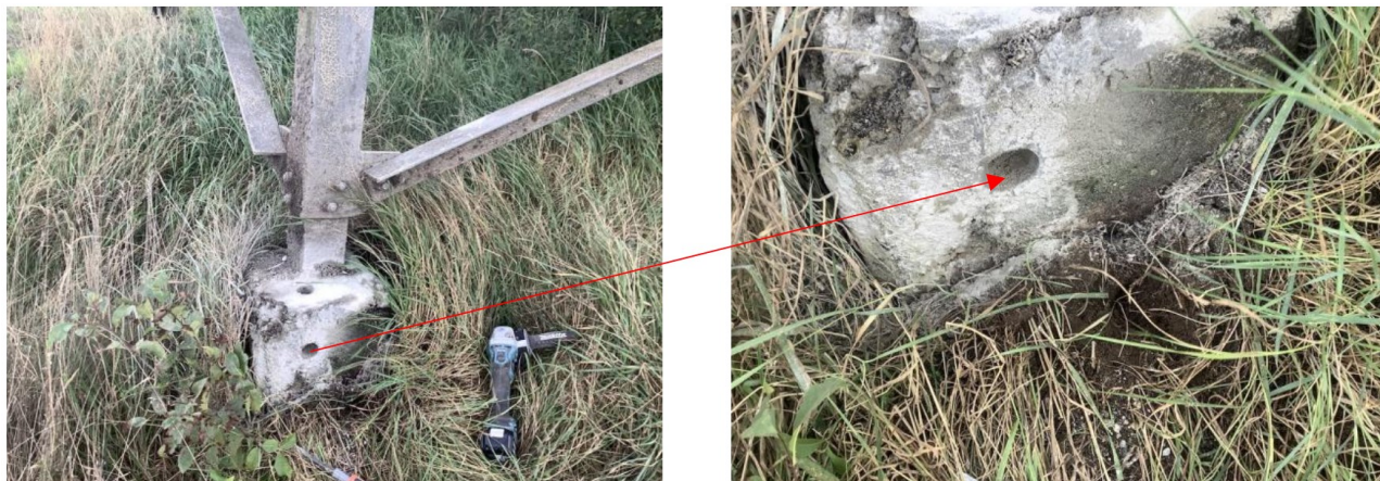
Figur 2-29. Eksempel på prøvetagning af betonfundament.
