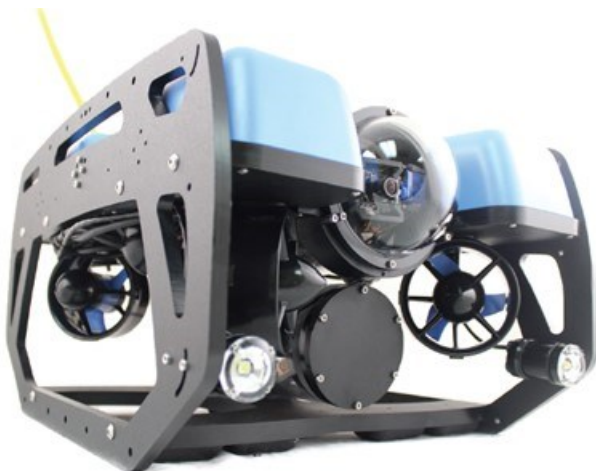
Figur 5-3. ROV af fabrikatet Blue ROV2, der blev brugt til de visuelle verifikationer.
