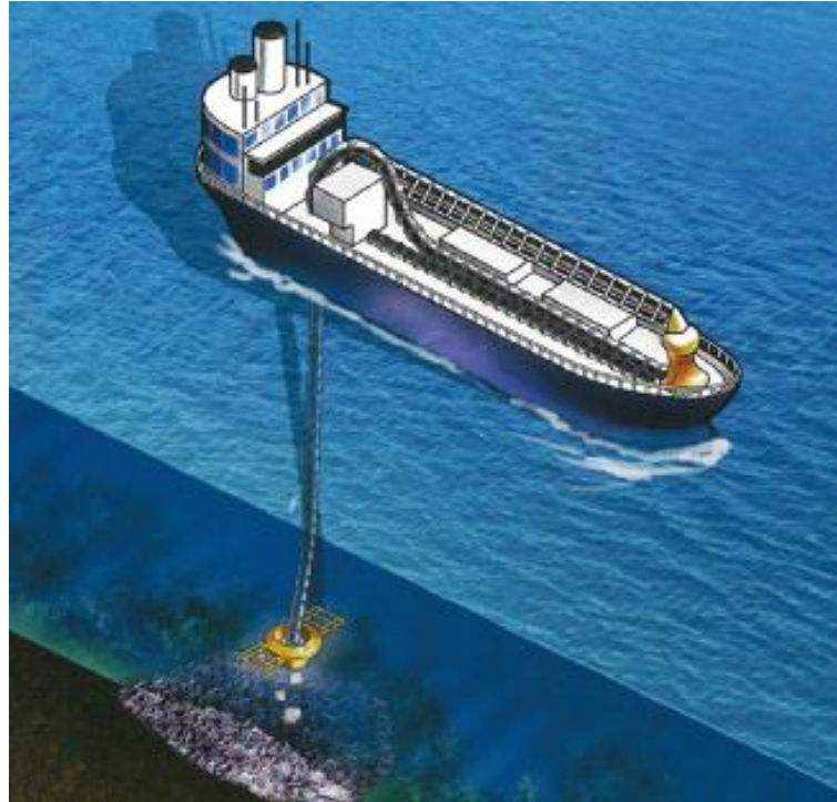
Figur 24: Hensigtsmæssig placering af stenmateriale på havbunden for at skabe beskyttelse mod opskyl (Kilde: Van Oord, Gemini Offshore Wind Park - a giant step towards a sustainable future, 2017)
