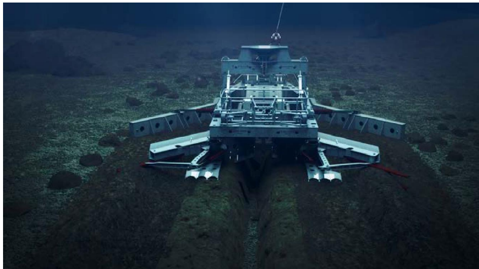
Figur 18: Eksempel på et bugseret værktøj til flytning/fjernelse af kampesten, herunder forgravning til et kabel (Kilde: Osbit)
