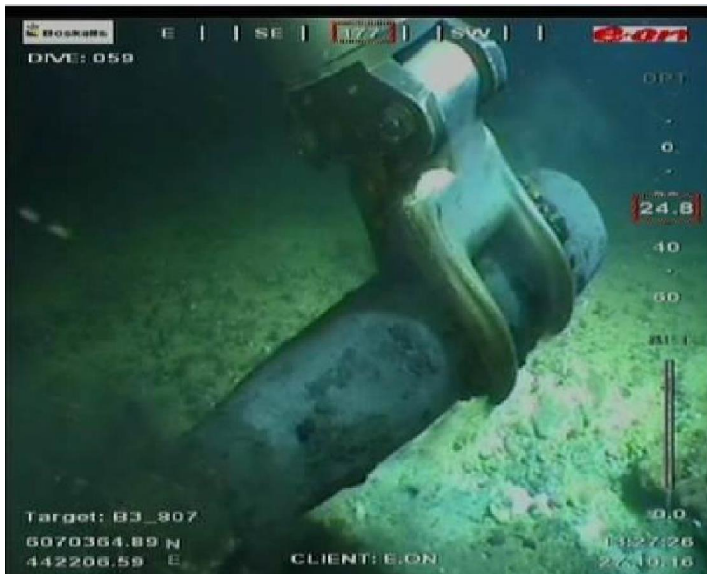
Figur 15: Eksempel på ammunitionsrydning med ROV (kilde: udviklerens materiale)
