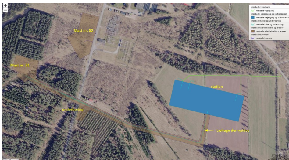
Figur 2.1. Kortudsnit af projektområdet, hvor af fremgår læhegnet på stationsområdet (blå firkant) matr. nr. 2æ, Mesballe by som ryddes helt i forbindelse med etablering af højspændingsstationen og arbejdsarealer (brune flader) ved mast 81 og 82, ved underboring og langs med kabelanlæg.
