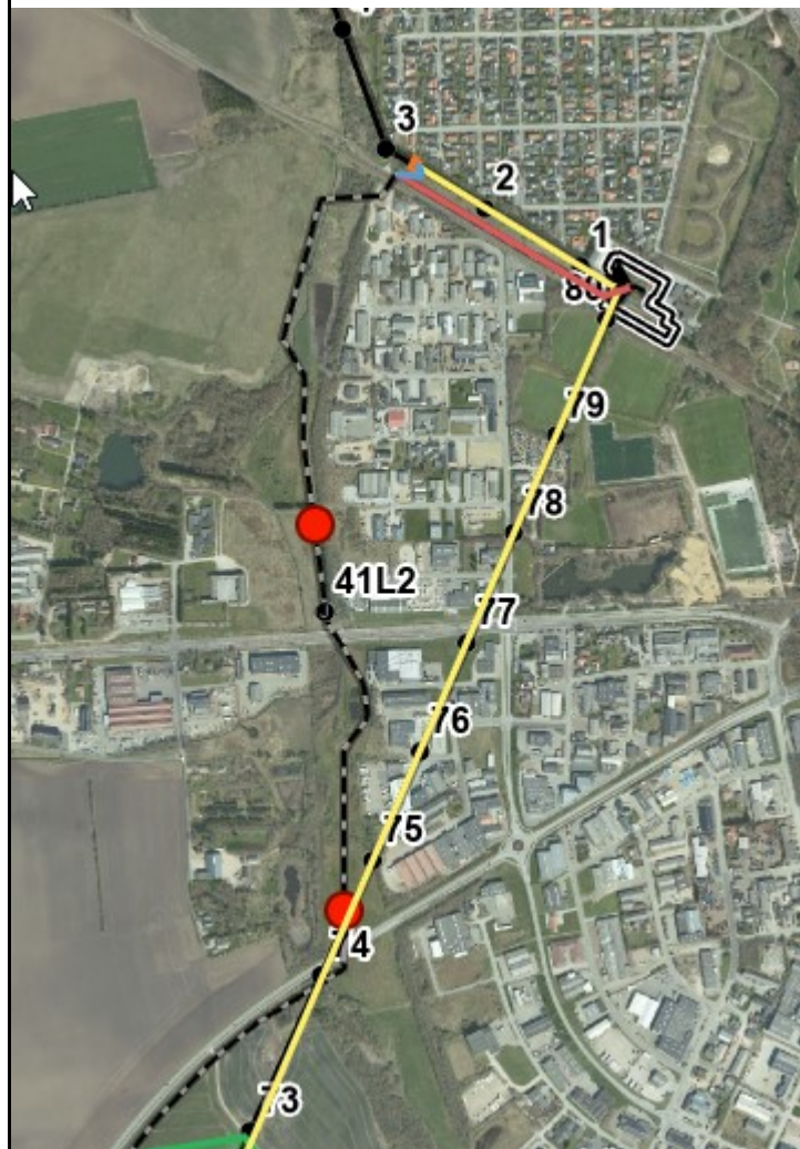
Figur 2 Placering af nye muffer på eksisterende kabel er angivet med røde cirkler.
