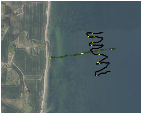
Figur 2.1. Et transekt består af et hovedtransekt (grøn linje) og et "T-stykke" den sorte zig-zag linje. Hovedudbredelsen bestemmes som gennemsnittet af største dybde langs hovedtransektet med mindst 10%'s dækning og med flere tilsvarende observationer langs T-stykket (gule punkter).
