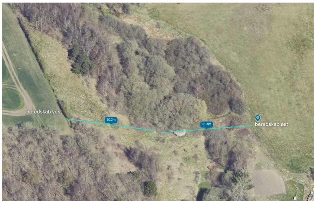
Figur 34 – kortudsnit (skråfoto) som viser adgangsforhold for beredskab ved den beskyttede mose og overdrev. Der etableres beredskab på vest og østsiden, hvor slanger fra slamsuger kan række ind i området og suge evt. boremudder væk.
