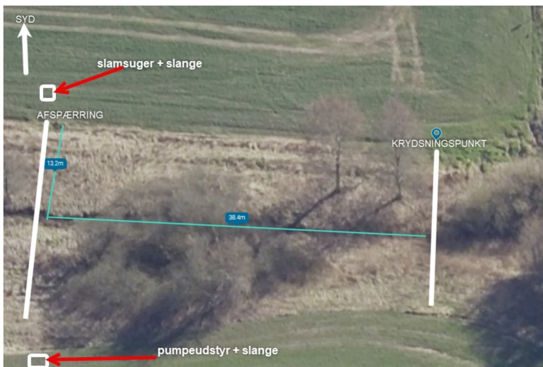
Figur 64 – kortudsnit fra skråfoto, som viser området ved krydsningspunktet. Det er indikeret hvor der planlægges etableret beredskab og afspærring af vandløbet, i tilfælde af et uheld.
