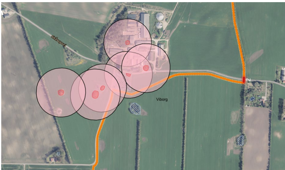
Figur 16 – Kortudsnit som viser tracéets krydsning af fortidsminde beskyttelseslinje for i alt 4 fortidsminder på lokalitet nr 1. På denne strækning følger tracéet en eksisterende gasrørledning.
