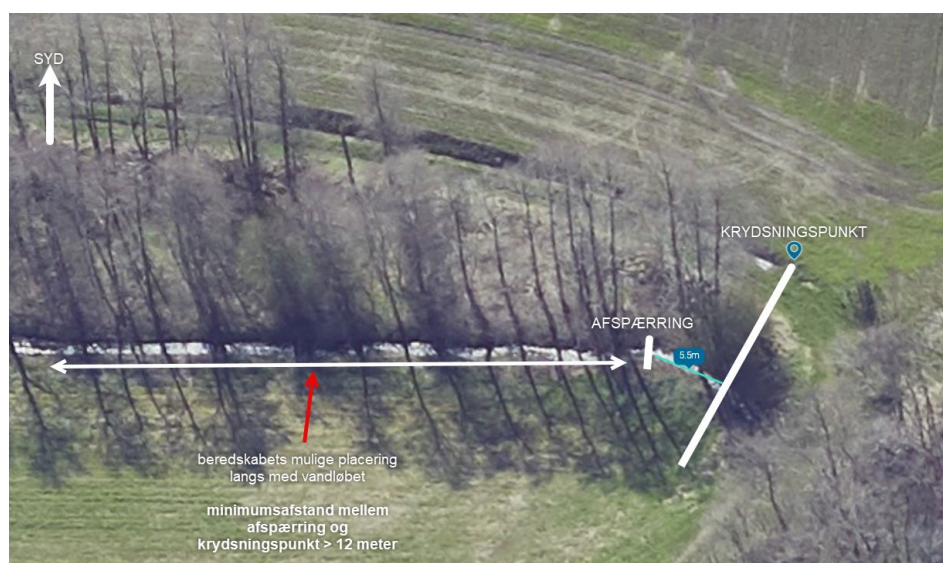
Figur 65 – kortudklip (fra skråfoto) som viser krydsningspunktet samt tættest mulige afspærringspunkt, som er placeret nedstrøms. Ved denne krydsning vil beredskabet placeres mellem 12 – 20 meter fra krydsningsstedet.
