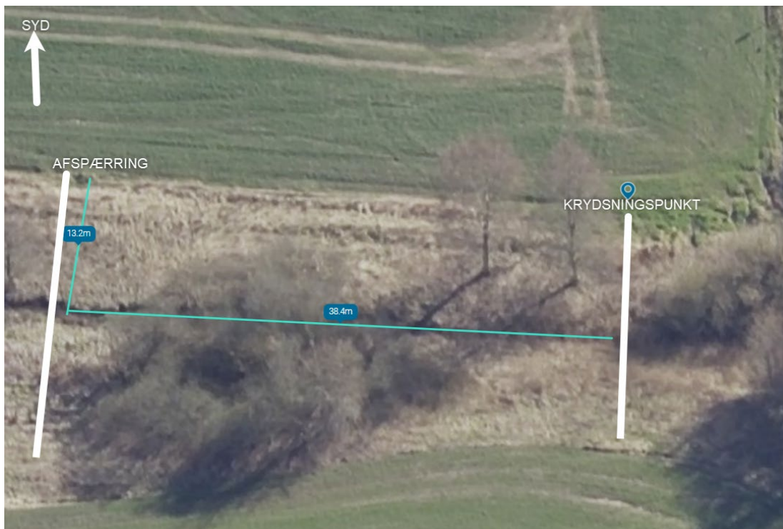
Figur 29 – kortudsnit (fra skråfoto) som viser krydsningspunkt ved UB6, samt lokation hvor det er muligt at afspærre vandløbet, hvis der sker et blow out. De 13 meter indikerer bredden af mosens fra vandløbskanten. De 38 meter er afstanden nedstrøms fra krydsningspunktet, hvor der kan foretages en afspærring. Beredskabet i form af slamsuger etableres udenfor mosens.
