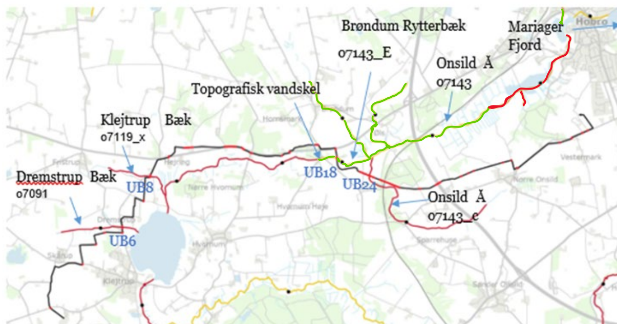
Figur 14. Projektet krydser fire steder målsatte vandløb med underboringerne UB6, UB8 og UB18 krydser åbne målsatte vandløb, mens UB24 krydser en strækning af det målsatte vandløb Onsild Å der er rørlagt. Farverne på vandløbene repræsenterer den samlede økologiske tilstand efter den nye basisanalyse til VP4 (grøn = god økologisk tilstand, gul=moderat økologisk tilstand, orange=ringe økologisk tilstand og rød= dårlig økologisk tilstand).
