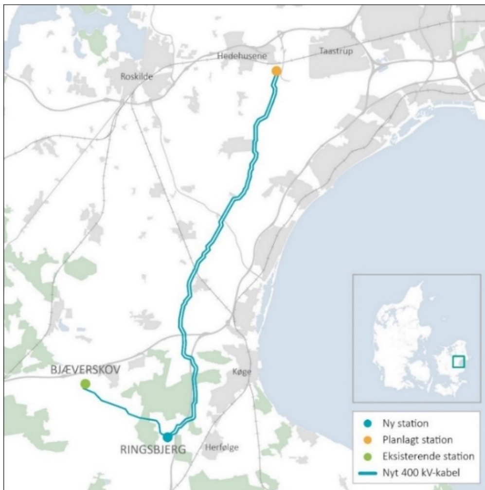
Figur 1.1 Placering af ny højspændingsstation ved Ringsbjerg (Ringsbjerg Højspændingsstation) samt nye kabelstrækninger til Bjæverskov og til en planlagt station ved Taastrup (Lindehøj Højspændingsstation).
