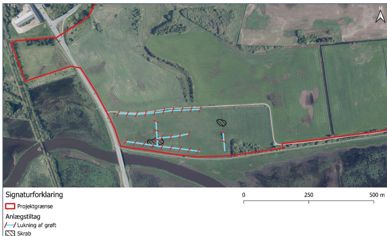
Figur 6-8 Lukning af grøfter i den sydvestlige del ved at foretage terrænskrab.
