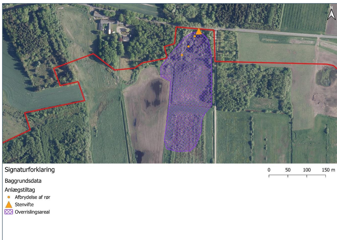
Figur 6-10 Afbrydelse af rørlægning og etablering af overrrisling.
