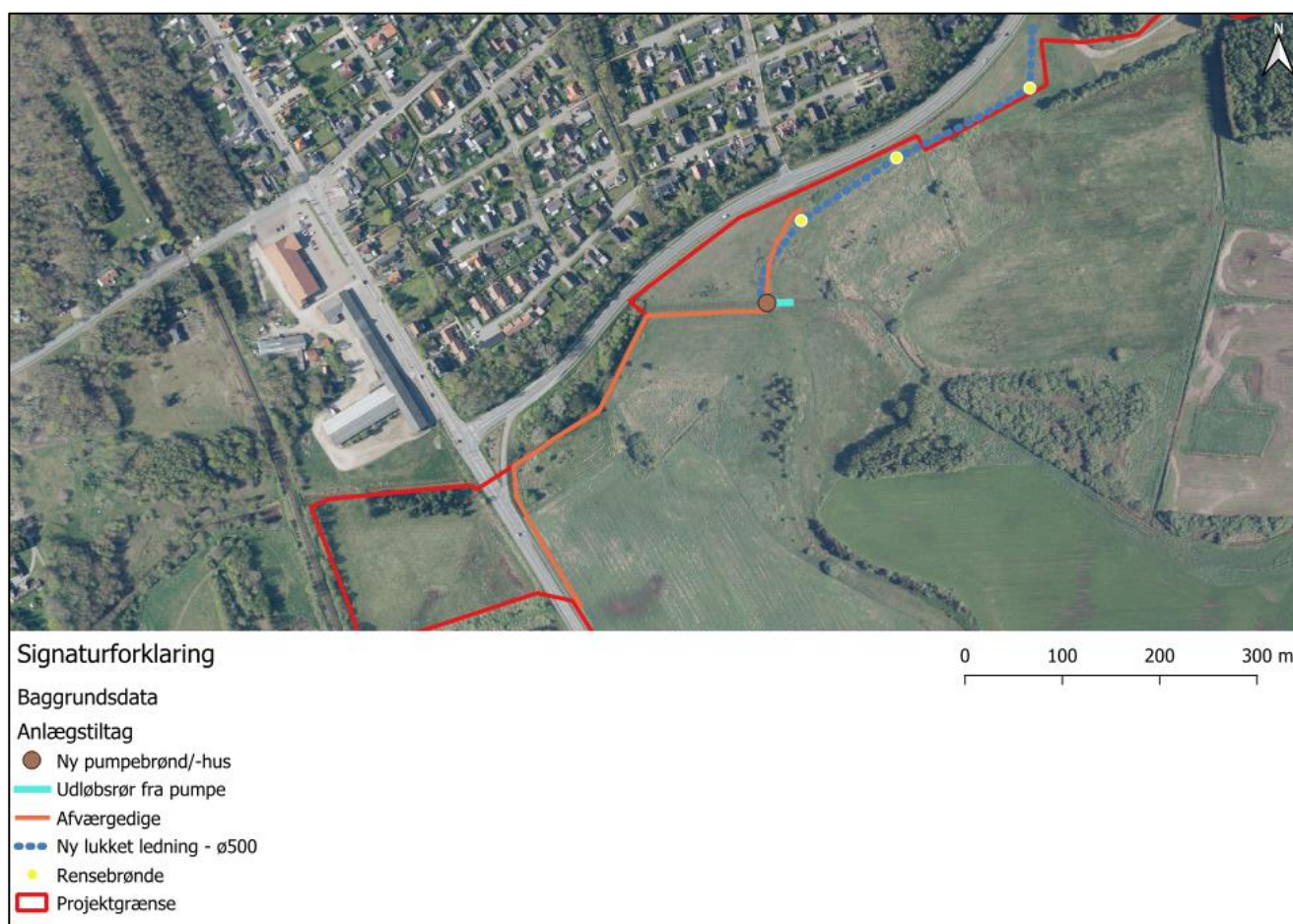
Figur 6-4 Anlægstiltag til sikring af afvanding mod nordvest.
