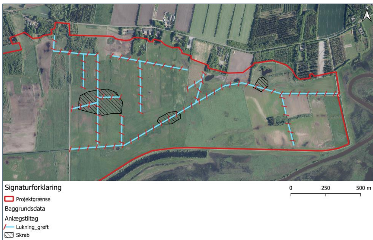
Figur 6-7 Lukning af grøfter i den østlige del ved at foretage terrænskrab.
