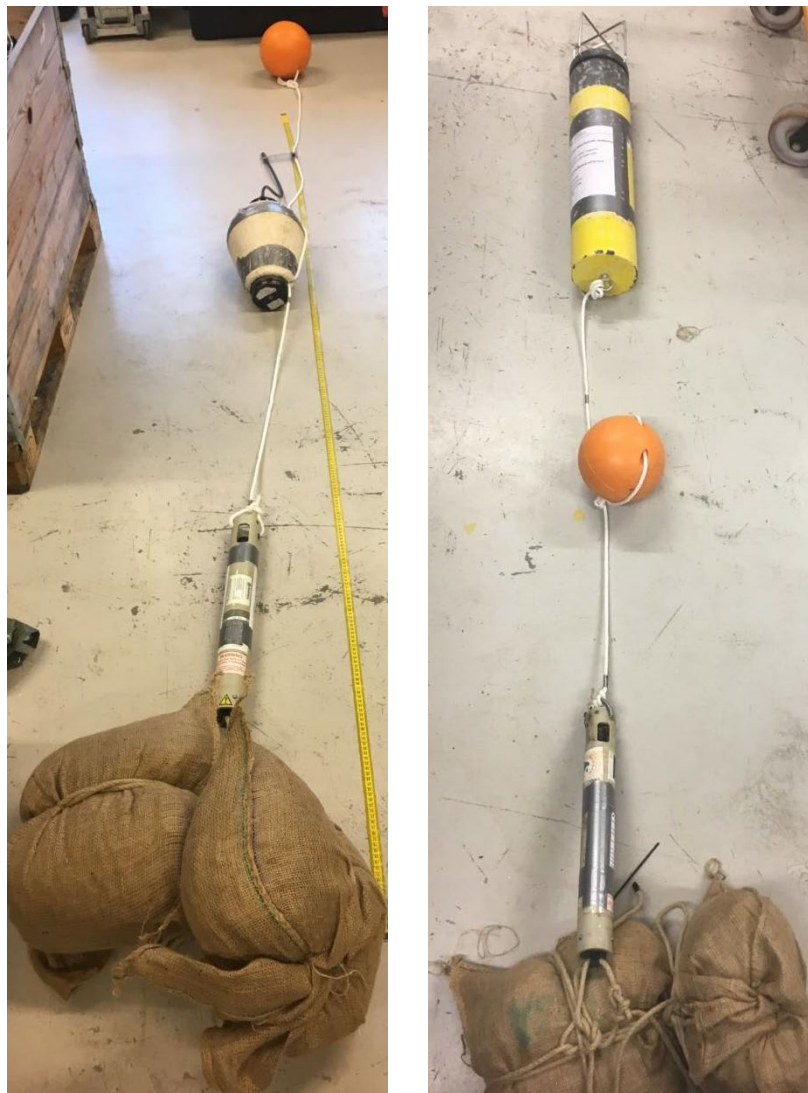
Figur 2.2. Eksempel på opsætningen af de to typer af målestationer. Venstre: Opsætning med ST500 dataloggeren. Højre: Opsætning med SM2M dataloggeren.
