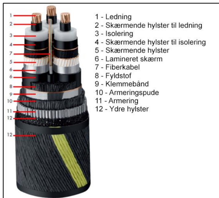
Figur 3.8. Opbygningen af en typisk trefaset elektrisk strømkabel, der arbejder i vekselstrømsteknologi (kilde: egen udarbejdelse)
