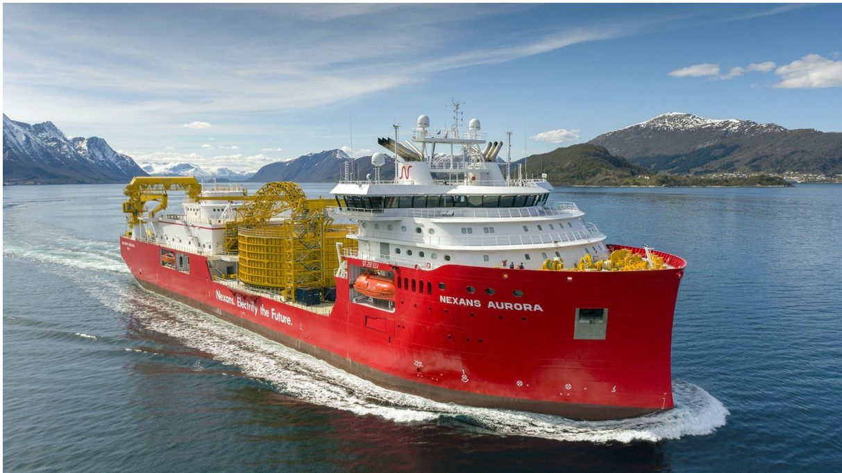
Figur 3.9. Eksempel på et kabelskib, der udfører omfattende arbejde i forbindelse med nedlægning af undersøiske kabelledninger (kilde: https://www.nexans.com/ )
