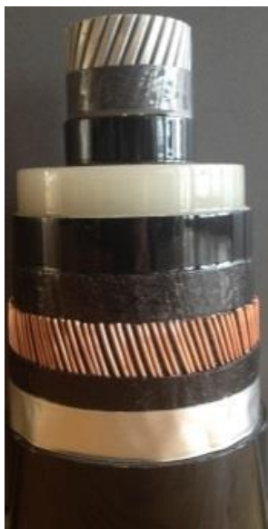
Billede 1. Eksempel på opbygning af 150 kV landkabel med komprimeret leder.
