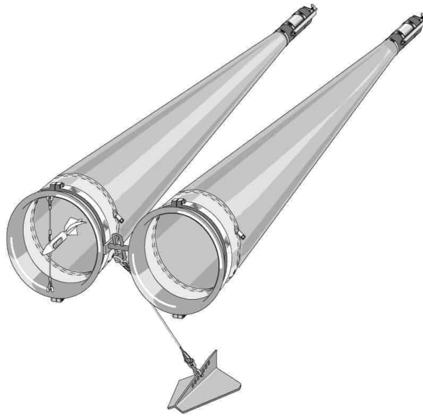
Figur 9. Diagram over et ichthyoplankton-indsamlingsnet af BONGO-typen
