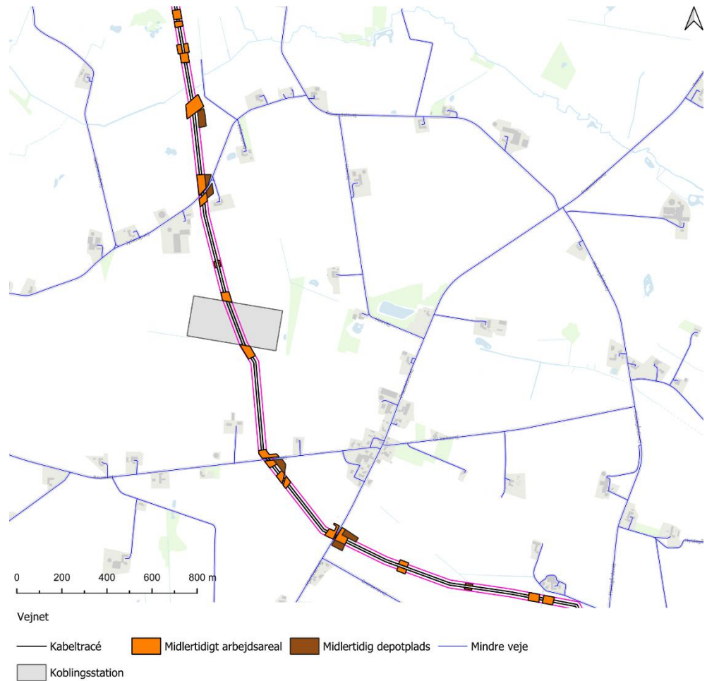
Figur 15: Kabeltracéets krydsning af Jyllerupvej, forløb forbi koblingsstationen samt krydsning af Roustvej og Hjortkærvej
