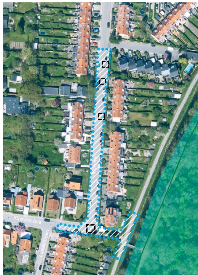
Byggepladsen for enden af Kirstens Allé og langs Mosevej. De sorte figurer er underjordiske bygværker.
