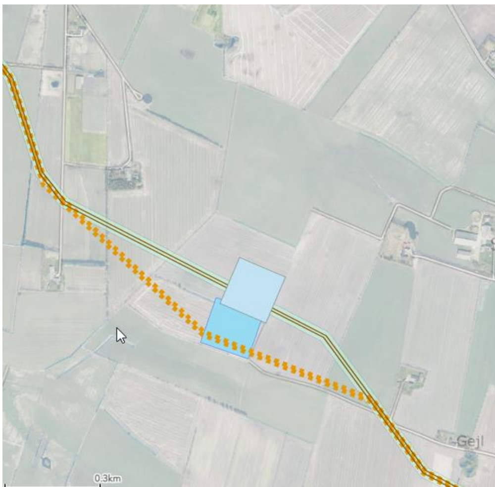
Figur 6 Projektændringer af linjeføringen af A2 og kompenseringsstationen øst for Nørre Nebel. Den gule prikkede linje angiver den nye linjeføring, og den grønne dobbelte linje er det oprindelige forslag. Kompenseringsstationen flyttes 130 m mod syd. Den mørkere blå firkant angiver den nye placering af kompenseringsstationen, den lysere blå firkant er det oprindelige forslag.
