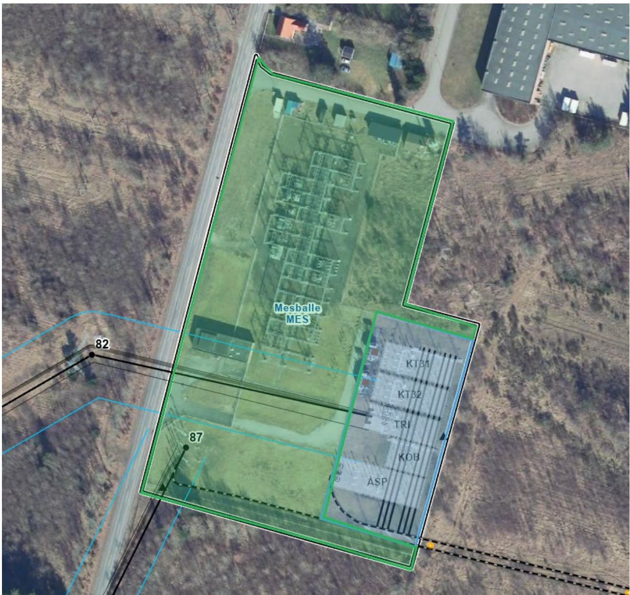
Figur 1-2. Eksisterende højspændingsstation Mesballe. Det grønne område er Konstants anlæg. Det blå er Energinets anlæg.
