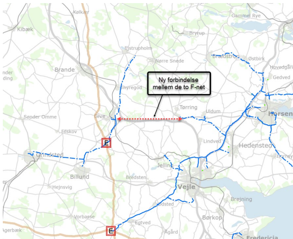
Figur 1: Skitse af F-net der forsyner området (blå streg) – Projektet omfatter ny Forstærkningsledning der forbinder de to F-net ved Givø og Tørring (rød stiple linje)
