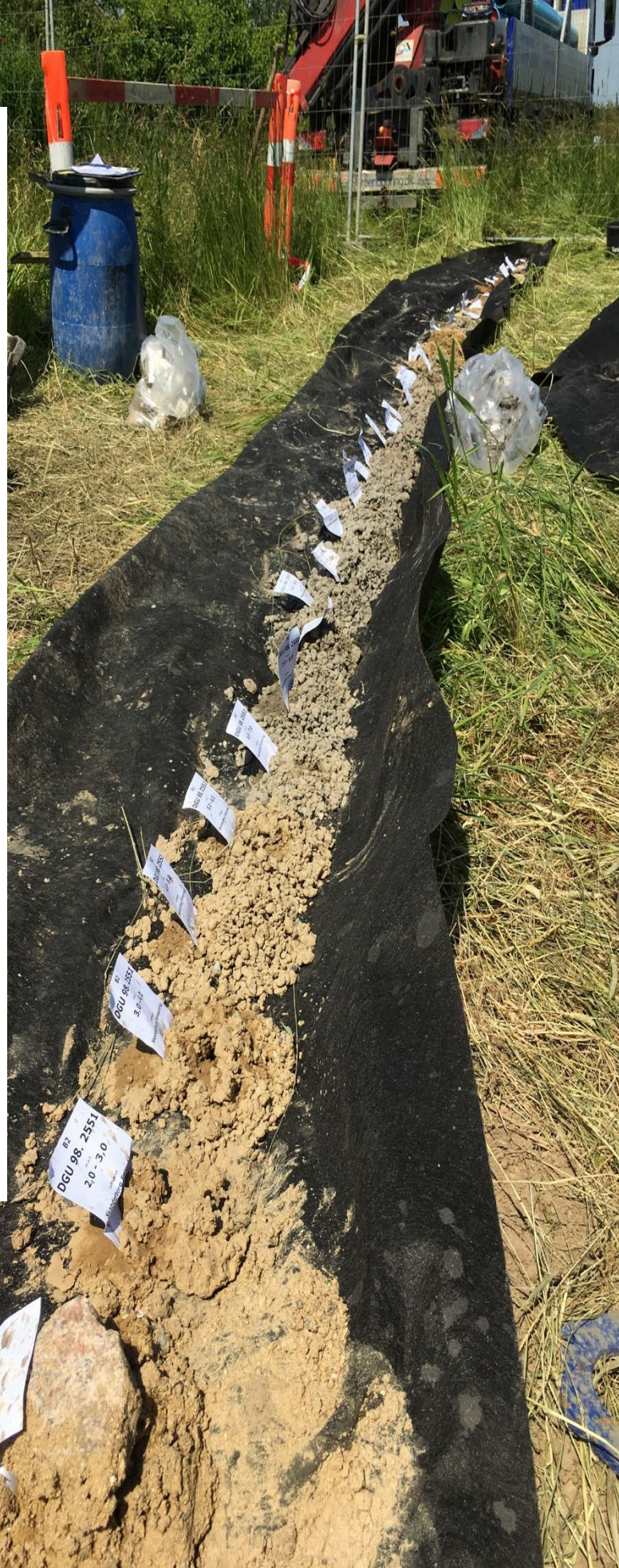
Prøveboring vest for Madpakkehuset i Anebjerg Skov, juni 2019. Jordprøver fra hver meter fotodokumenteres og klargøres til laboratorieanalyser.
