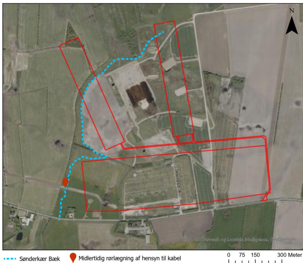
Figur 3-13 Forløbet af Sønderkær Bæk i den 2-årige periode mellem de to etaper af vandløbsomlægningen, og placering af midlertidig rørlægning i vest.
