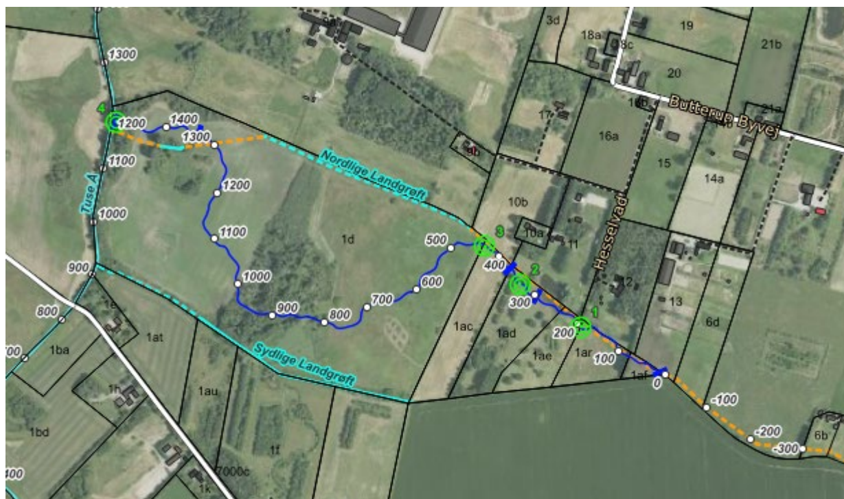
Figur 3-1 Kort der viser nyt vandløb gennem Ellinge Enghave samt den Nordlige Landgrøft der nedlægges fra st. 10. Broer er vist med grøn signatur.
