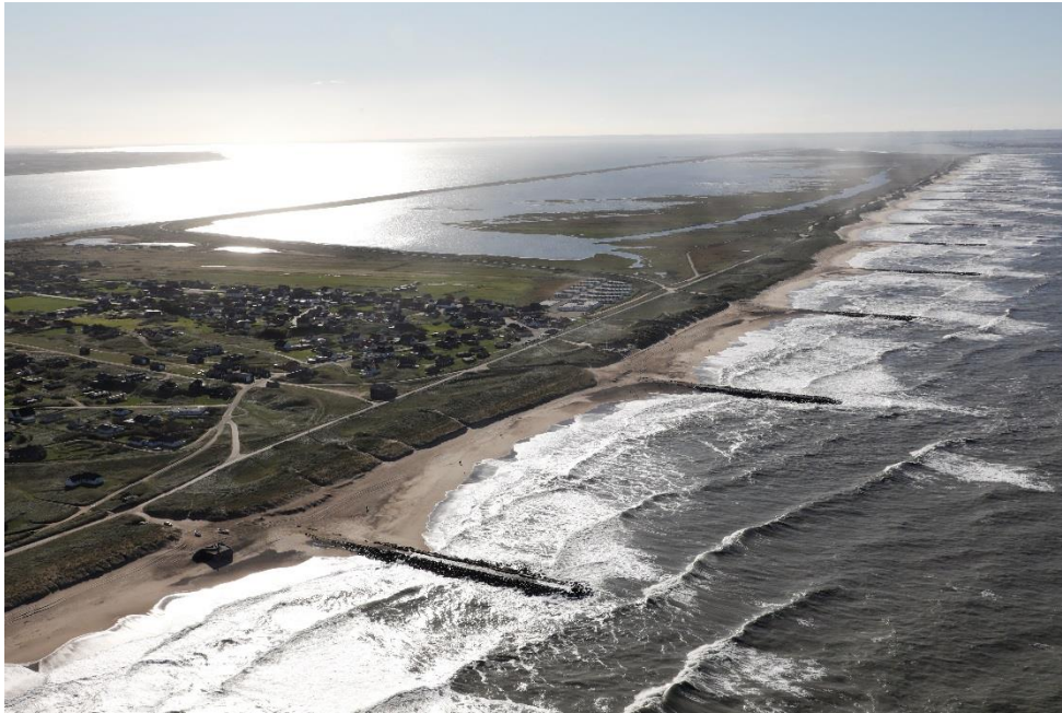
Figur 8-7. Eksempel på høfder. Fotokilde: Kystdirektoratet
