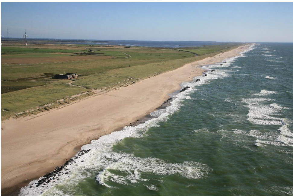
Figur 8-7. Eksempel på bølgebrydere. Fotokilde: Kystdirektoratet
