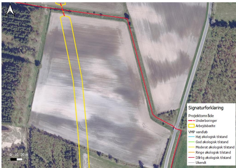
Figur 4-57 Underboringen eller gennemgravningen til tilløbet til Dambæk med beliggenhed af underboringen ved Dambæk (o3293).
