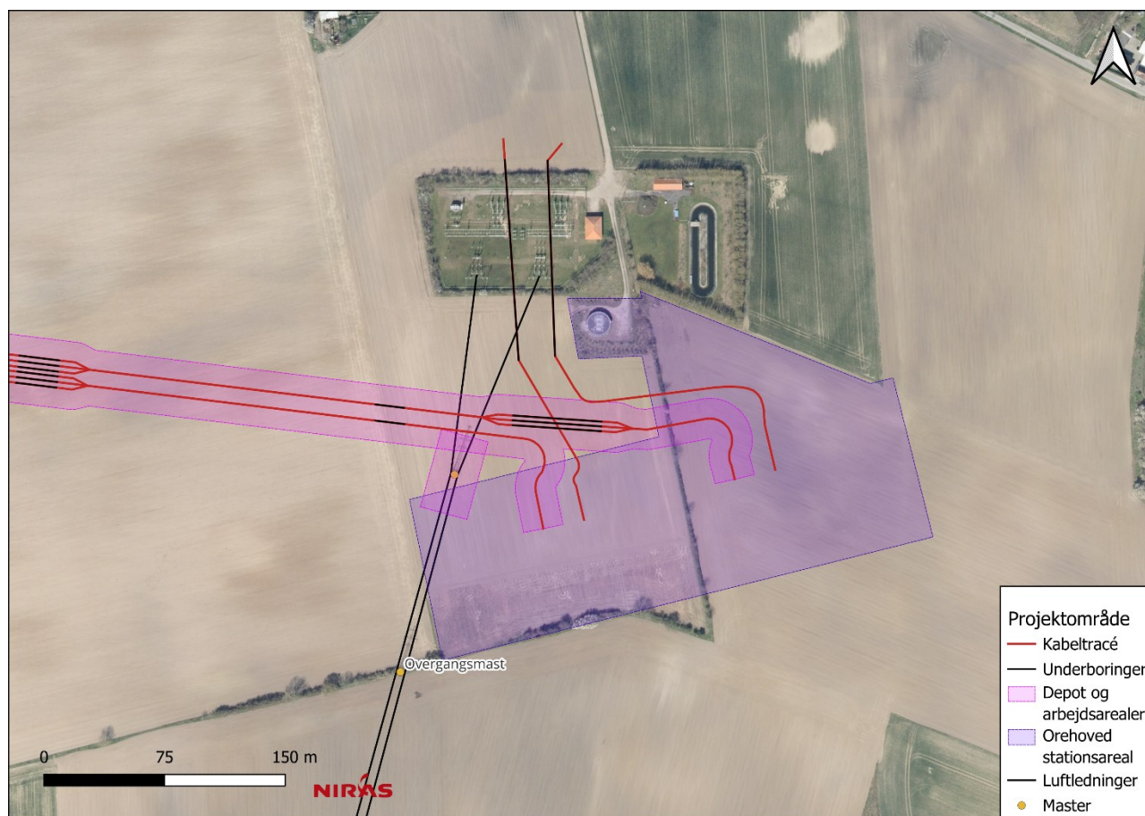
Figur 19.1 Placering af overgangsmast ved Orehoved stationsareal.
