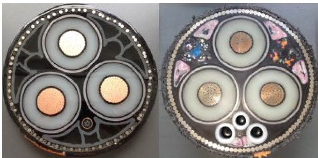
Figur 3.16 Illustration af opbygning af søkabel med tre ledere – Til venstre fyldmateriale af plastik, til højre fyldmateriale af garn.
