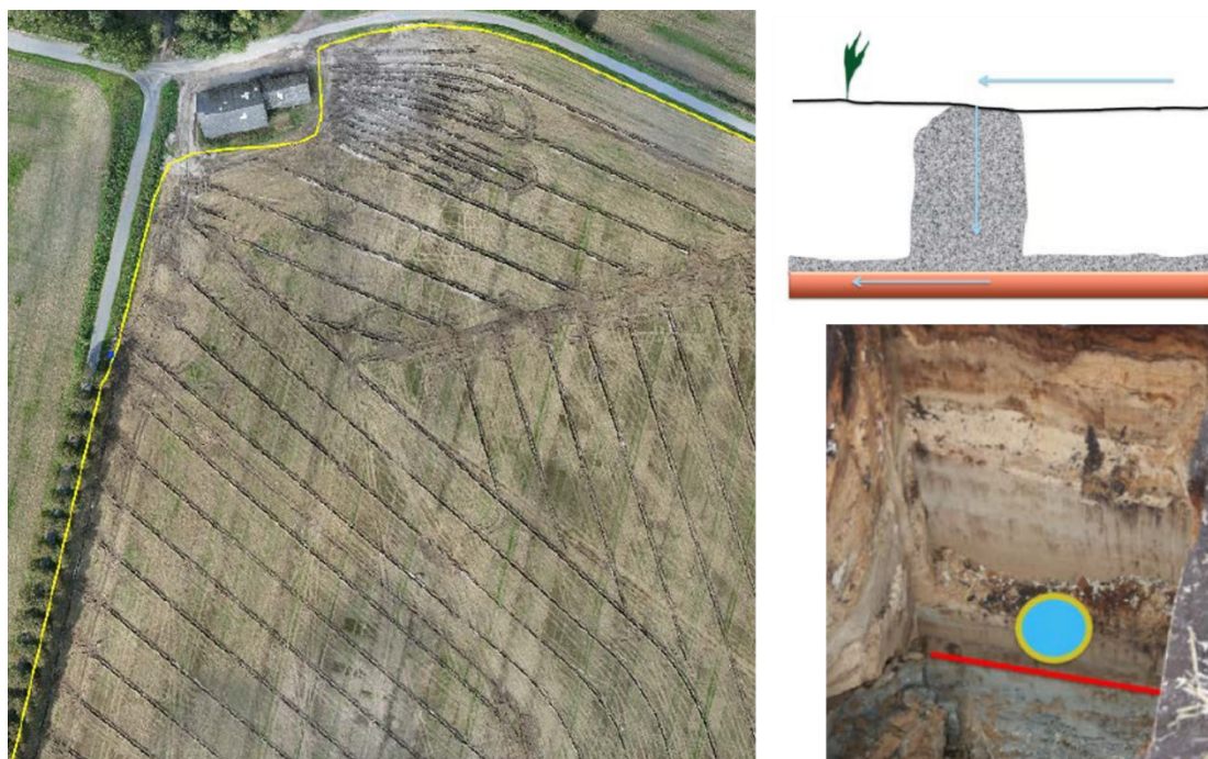
Figur 8.3 Ortofoto af nydrænet mark, hvor brønde og markgrænser er optegnet. Til højre ses øverst skitse af dræn med grus omkring, og hvordan markdrænen skal lægges over et uigennemtrængeligt lerlag (lysegråt) i en sandet jord.
